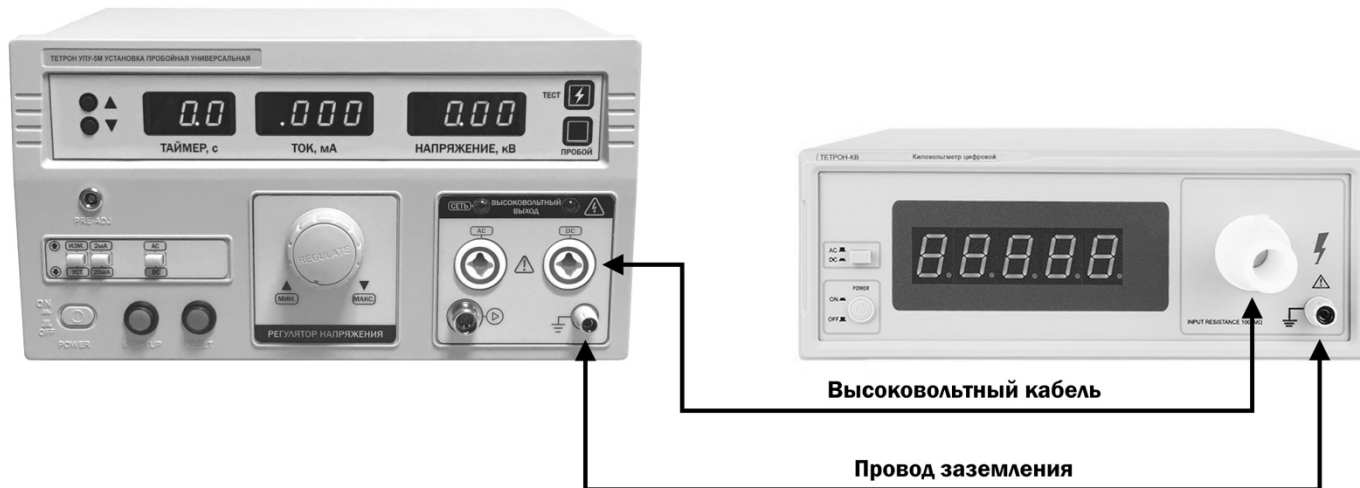
Пример подключения киловольтметра к высоковольтной испытательной установке
