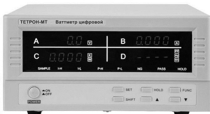
В верхней части передней панели находится окно дисплея, которое разделено на пять зон отображения: верхние четыре зоны А, В, С и D
