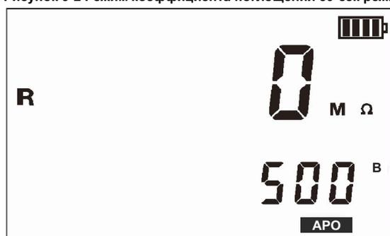
Рисунок 9-4 Режим измерения сопротивления изоляции
