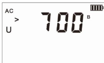
Рисунок 11-2 Интерфейс установки значения напряжения переменного тока
