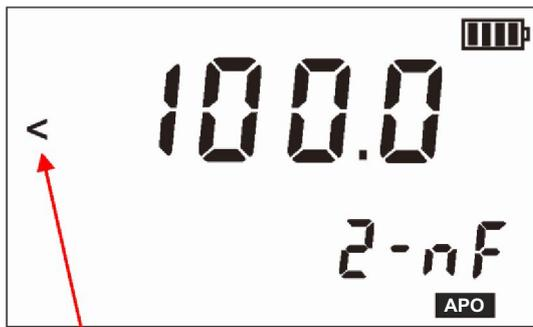
Рисунок 6-3 Завершение измерения со значением меньше чем
