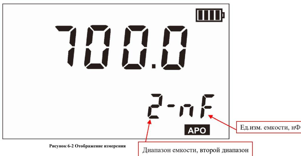
Рисунок 6-2 Отображение измерения
