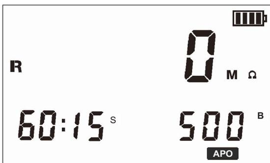
Рисунок 9-1 Режим коэффициента поглощения 15-сек режим
