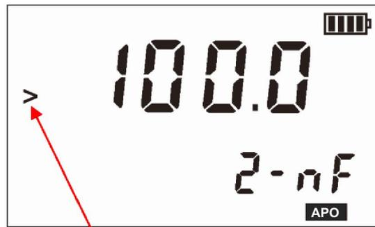
Рисунок 6-3 Завершение измерения со значением больше чем
