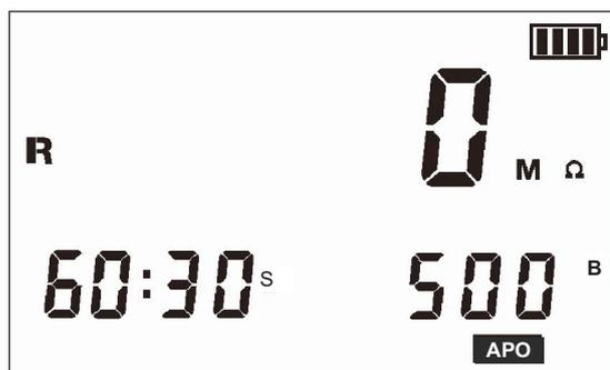
Рисунок 9-2 Режим коэффициента поглощения 30-сек режим
