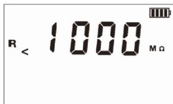
Рисунок 11-1 Интерфейс установки значения сопротивления
