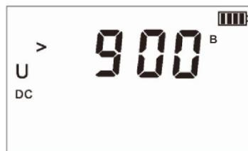
Рисунок 11-3 Интерфейс установки значения напряжения постоянного тока
